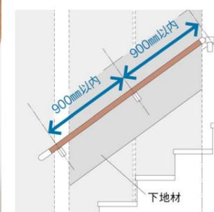
丸棒手すりは木製を採用しており、ブラケットの取り付け間隔は最長900mmまで可能。
